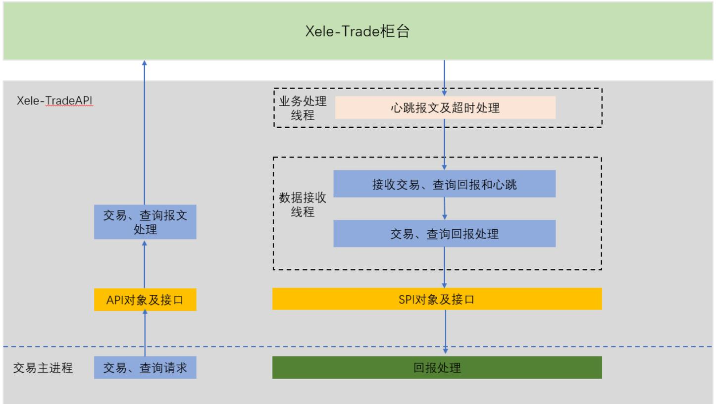
用户客户端通过API的请求接口可以向柜台发送相关请求，通过继承API的SPI回调函数，可以接收到相关响应和回报。
